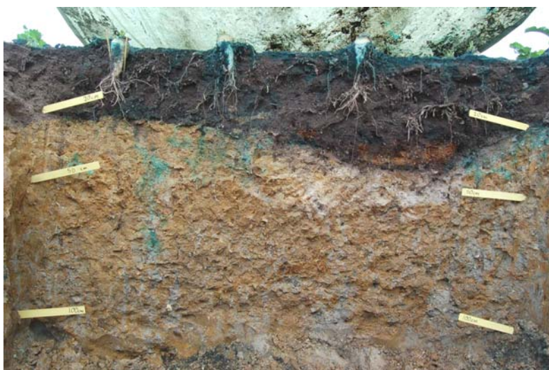
Bild 2. Markant annorlunda jordskikt på Karlsfält. Denna förtätning hindrade den vertikala vattentransporten och försvårade bedömningen av hur åtgärderna på fältet påverkade betgrödan.
