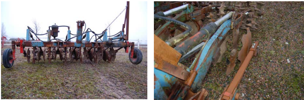
Bild 2. Maskinen som användes för partiell bearbetning. En kultivatorpinne står för bearbetningen, en tallrik på varje sida skyddar området mellan raderna och sist återpackar två vält-ringar.
